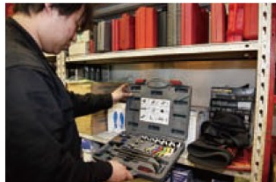
世界のクルマの特殊工具も完備。写真はアメリカ車の冷却ホースを交換するための専用工具という。
