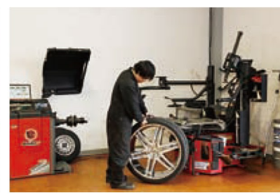
タイヤチェンジャーは写真の26インチまで対応。柳下遼太郎整備部長と比べると、大径ぶりがわかる。
