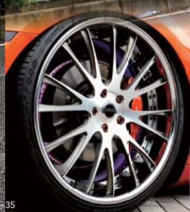
メインは8本としながらも、さらにリムに向かって2本に分岐させる細身のスポークはエレガントさを演出しながらも、スポークにわずかなラウンドを付けた曲線美が秀逸なホイールは、MPCフォードのMPC5 TOKA。サイズは22インチ。さらにその裏には、ボディカラーと同色にペイントしたブレーキキャリパーが覗かせる。
