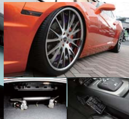
極低車高をもたらしエアサスにはアキュアーをチョイス。一瞬にして上下動を可能とする高性能タイプがインストールされている。
